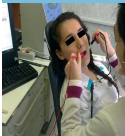
Рисунок 4. Методика измерения динамического электрохимического потенциала
